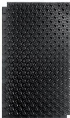
Panel aislante CABEL con tetones, en poliestireno expandido, autoextinguible (Euroclase E), de 10, 18 y 25mm de espesor útil, densidades de 30 y 25 kg/m<sup>3</sup> respectivamente. Provisto de tetones moldeados para la fijación del tubo con separaciones en múltiplos de 50 mm, y perfiles perimetrales machihembrados para el montaje; con lámina de poliestireno termoformado, color negro, de 600 µm de espesor.
