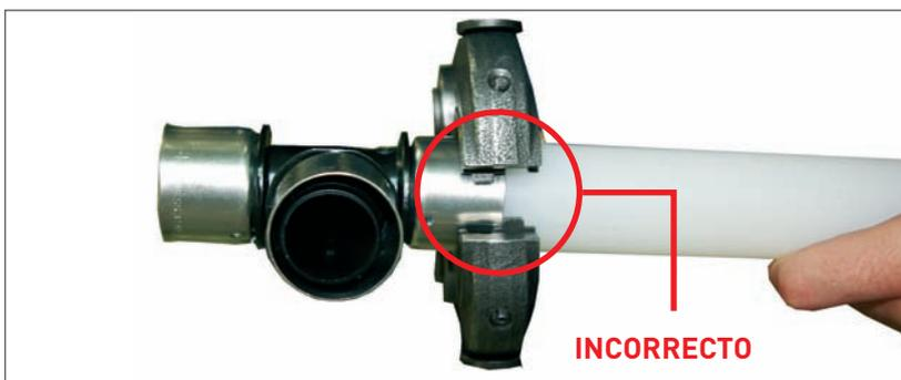
5. Insertar la cuna adecuada al diámetro exterior del tubo que se está conectando. Colocar la boca de la prensa centrada en el casquillo, pegando a la balona (No presar nunca fuera del casquillo).
